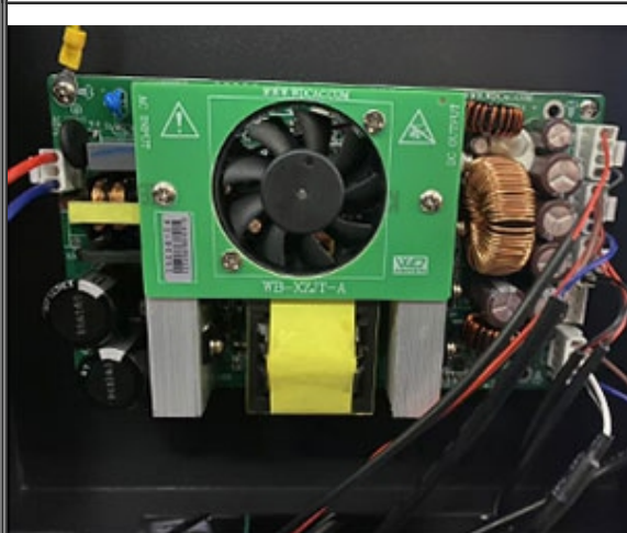
Fuente de alimentación integrada, con control de potencia más estable y mantenimiento sencillo.
