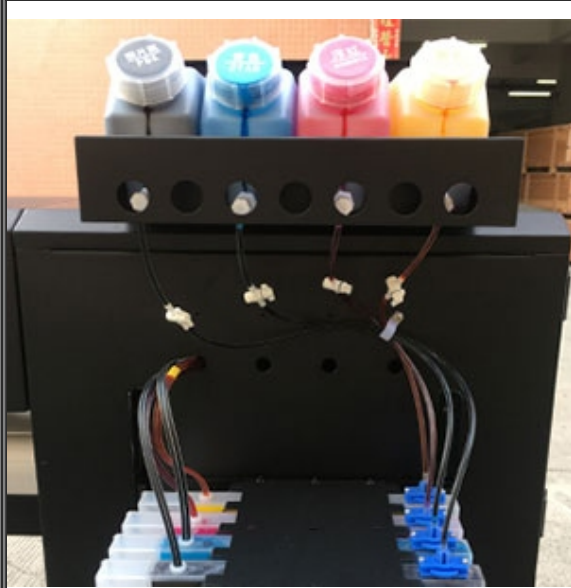
Sistema de suministro continuo que aumenta la capacidad de almacenamiento y la presión de tinta, reduciendo el riesgo de que la tinta se agote durante la impresión.
